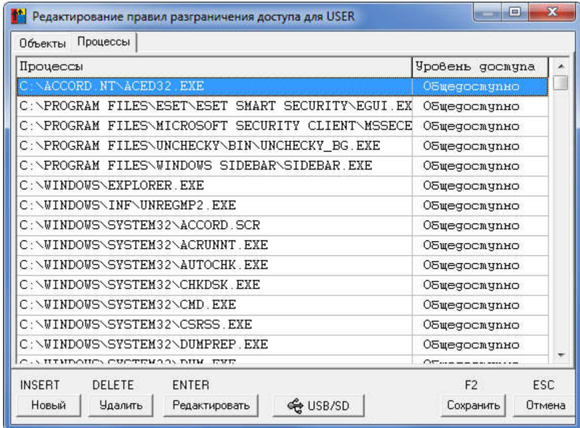
**Рисунок 62 - Закладка «Процессы» при включенном механизме мандатного доступа для процессов**
