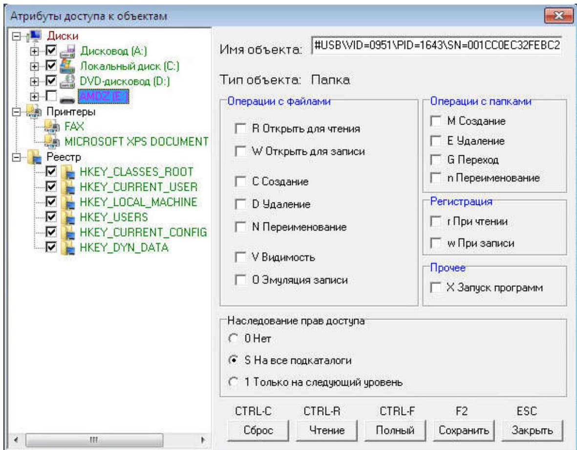
**Рисунок 52 - Выбор USB-устройства и установка ПРД**
